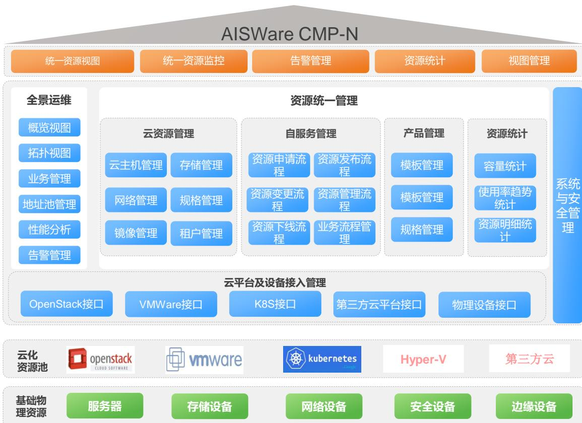
图2 AISWare CMP-N总体架构
